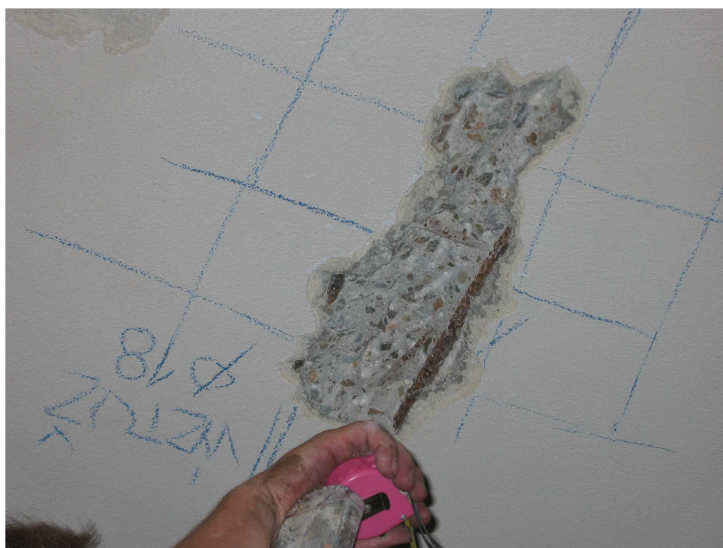
Foto 23 Sonda k výztuži stropní konstrukce nad 1. PP
