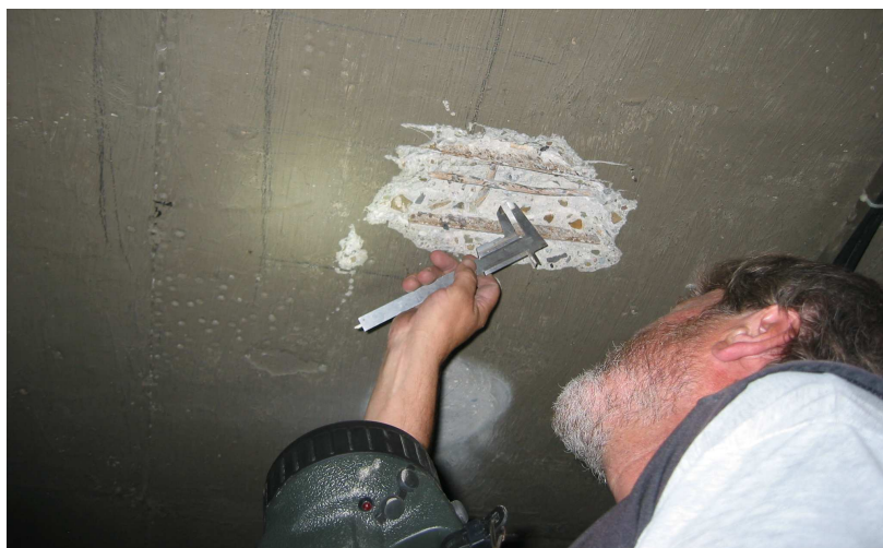
Foto 31 Sonda k výztuži přestrojení kolektorů pod výstavní plochou
