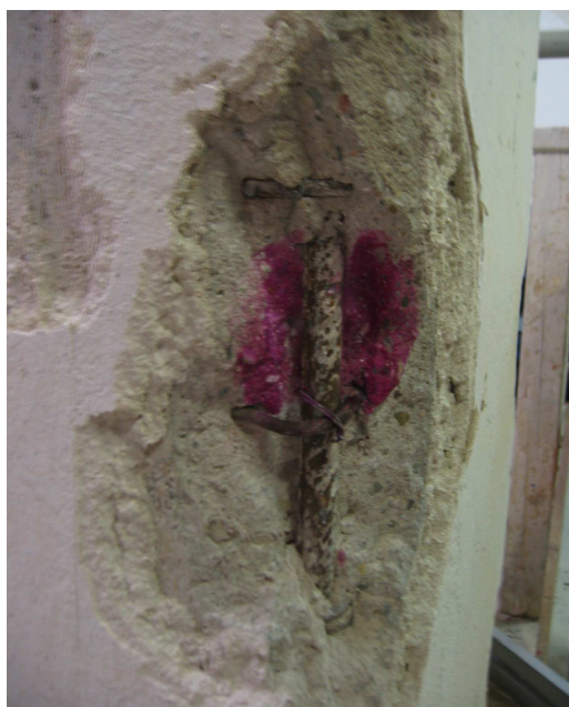
Foto 28 Sonda k výztuži sloupů 1. PP – test karbonatce – hl. max. 10mm
