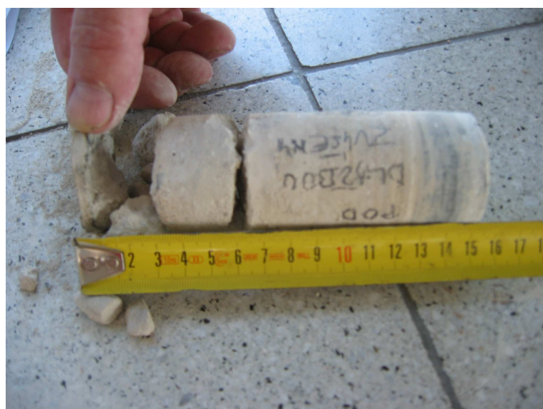
Foto 59 Skladba sondy z podlahy nad tiskárnou
