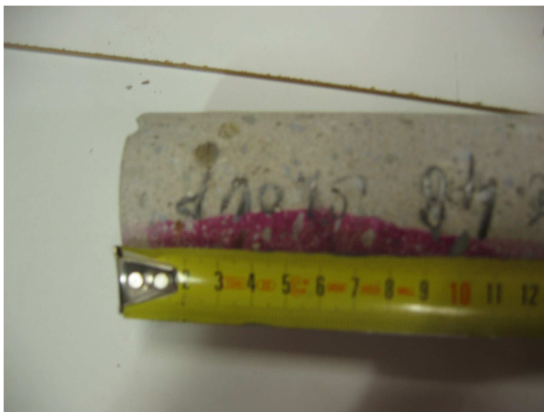
Foto 60 Měření karbonatace na vývrtech sloupů – zjištěná hloubka 5 – 10 mm
